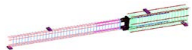
A) FESTKÖRPER-ELEMENTE DER STÜTZE, DES FUNDAMENTS UND DER LAST- BZW. LAGERPLATTEN
