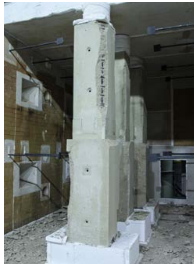
BILD 25: PROBEKÖRPER NACH ABSCHLUSS DER BRANDVERSUCHE
