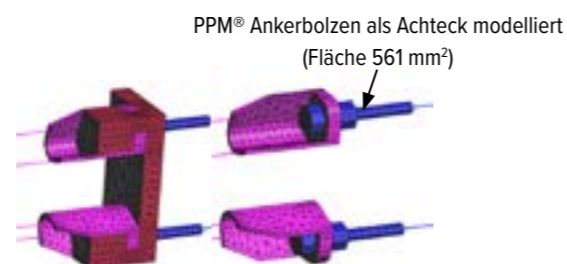
C) FE-MODELL DER STÜTZENSCHUHE [18]
