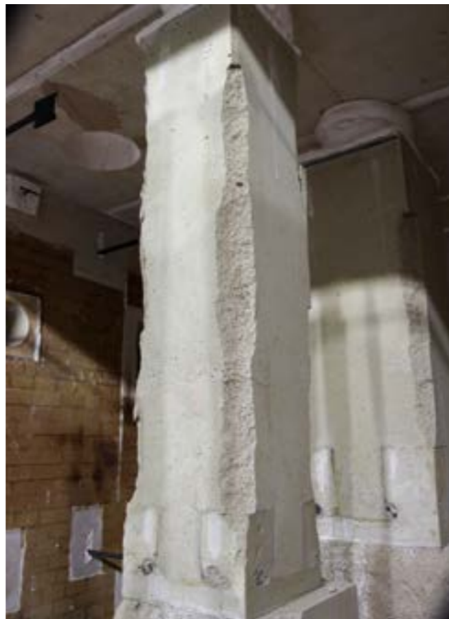
BILD 24: PROBEKÖRPER IM BRANDRAUM UND ANORDNUNG DER THERMOELEMENTE [12]
