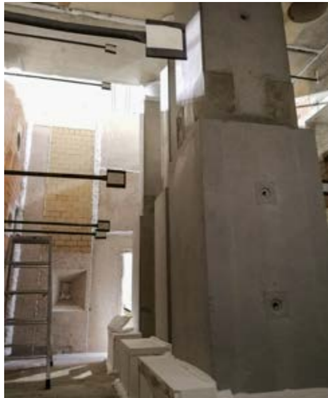
BILD 24: PROBEKÖRPER IM BRANDRAUM UND ANORDNUNG DER THERMOELEMENTE [12]
