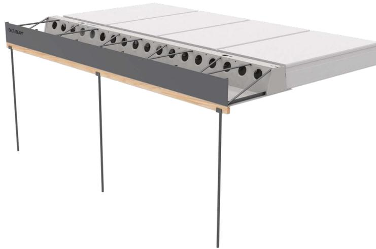
Ausmittig aufgelagerte Träger, lange Stützweiten oder große Abstützhöhen müssen besonders beachtet werden. Wenn die Abstützung nicht sehr hoch ist, werden herkömmliche Mittel wie z. B. Hilfsstützen oder Schwerlast-Türme eingesetzt. Peikko kann spezielle Lösungen zur Unterstützung und Torsionssicherung im Bauzustand anbieten. Diese müssen bereits in der Planung und Bemessung der DELTABEAM® Verbundträger berücksichtigt werden.
